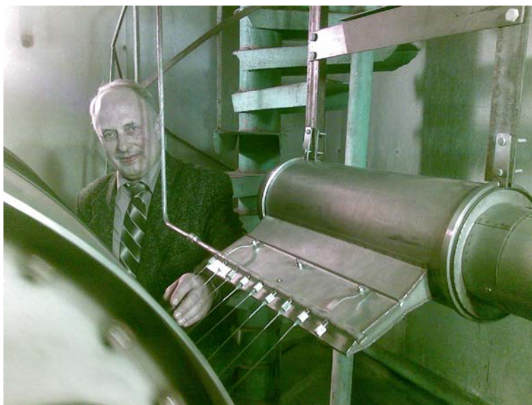
Рис.6. Наладка системы аэрозольного охлаждения заготовки
