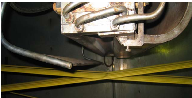
Рис. 4. Внешний вид обработки заготовки нефтепогружного кабеля.
